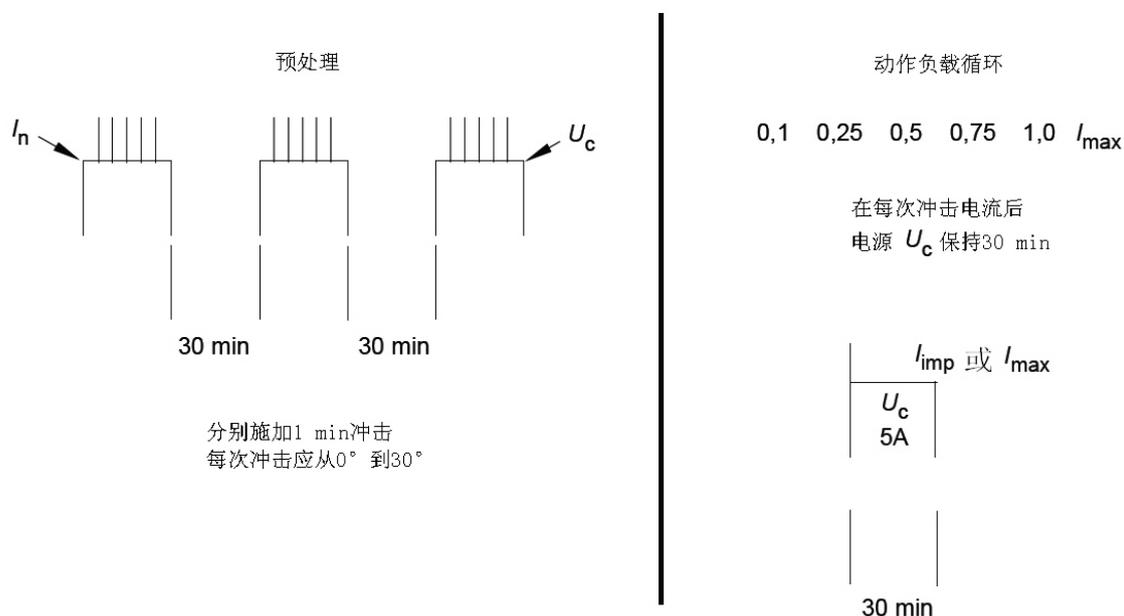
图6 预处理和动作负载循环试验程序
