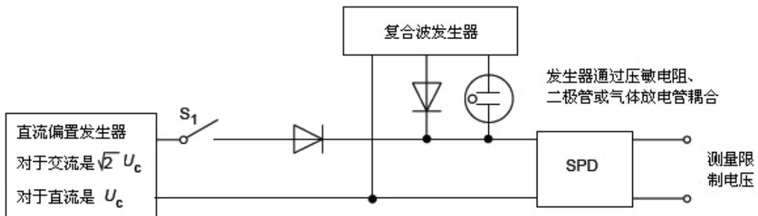
图4 测量限制电压的替代试验
