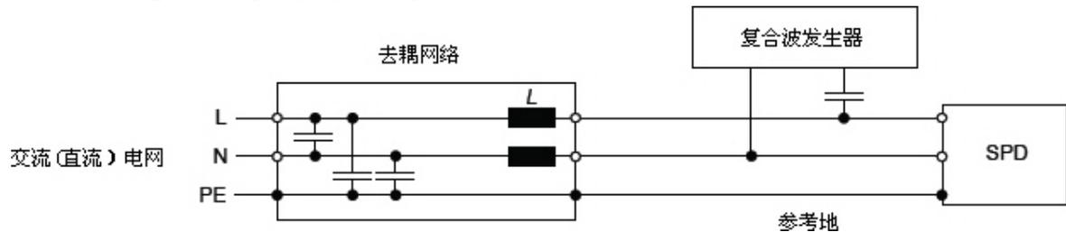
图1 用于单相电源去耦网络的示例
