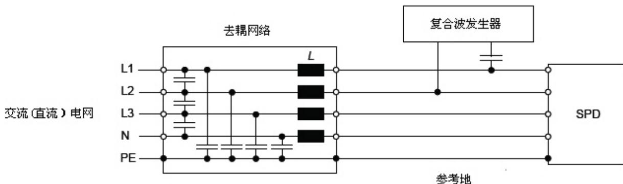
图2 用于三相电源去耦网络的示例
