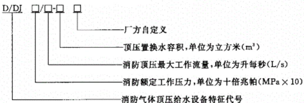
示例 1:D 6/10-6 表示通用型消防气体顶压给水设备,消防额定工作压力为 0.6 MPa,消防顶压最大工作流量为 10 L/s,消防顶压置换水容积 6  $m^3$ 。
